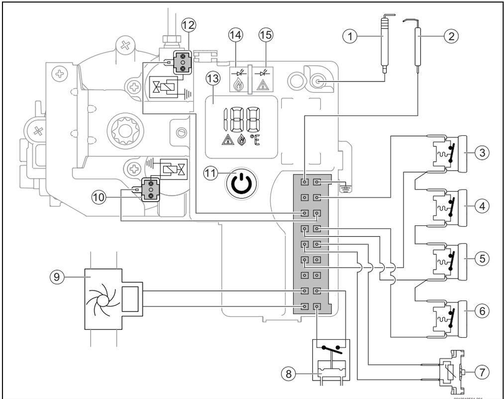
Fig. 28 Schéma de câblage
