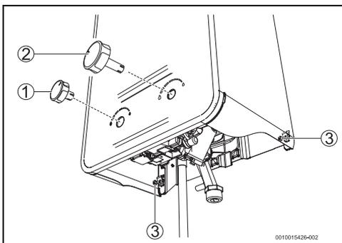
Fig. 13 Retirer le carénage
