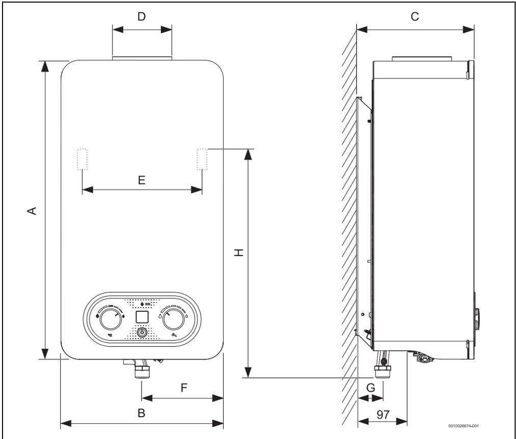
Fig. 1 Dimensions (en mm)
