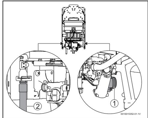
Fig. 12 Raccordement d'eau
